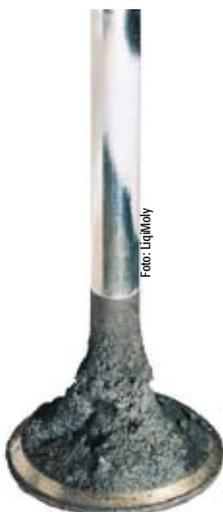
Ablagerungen dieser Art treten hauptsächlich an den Einlassventilen auf und können mit einem Kraftstoffadditiv entfernt werden. Öladditive sind hier nutzlos.
