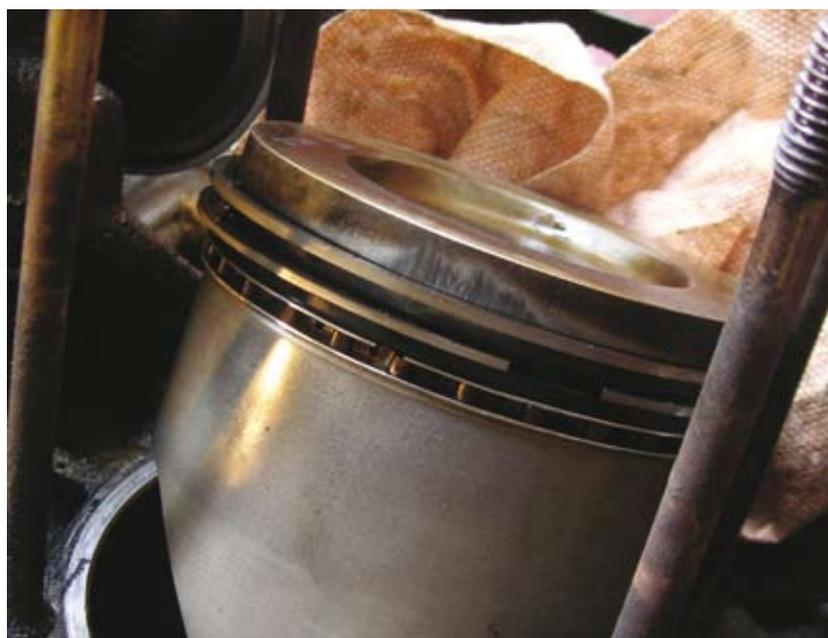
**In Kolbenringnuten abgesetzter Ruß kann unter Umständen mit einem Reinigungsadditiv gelöst werden.**
