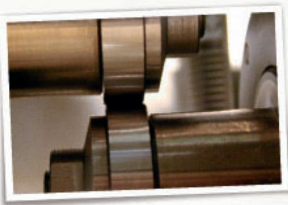
Wälzverschleiß-Untersuchungen am 2-disc-Prüfstand.
