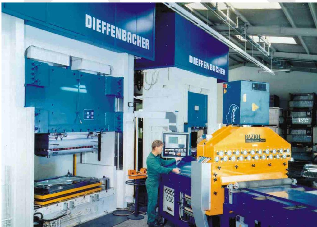
Umformpresse mit einer daneben angebrachten Befettungsmaschine (Maschinenfabrik J. Dieffenbacher GmbH & Co., D-Eppingen)
