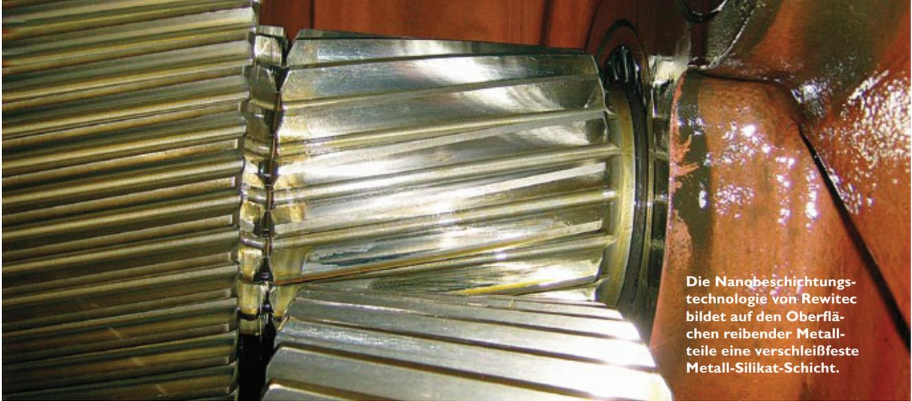
Die Nanobeschichtungstechnologie von Rewitec bildet auf den Oberflächen reibender Metallteile eine verschleißfeste Metall-Silikat-Schicht.
